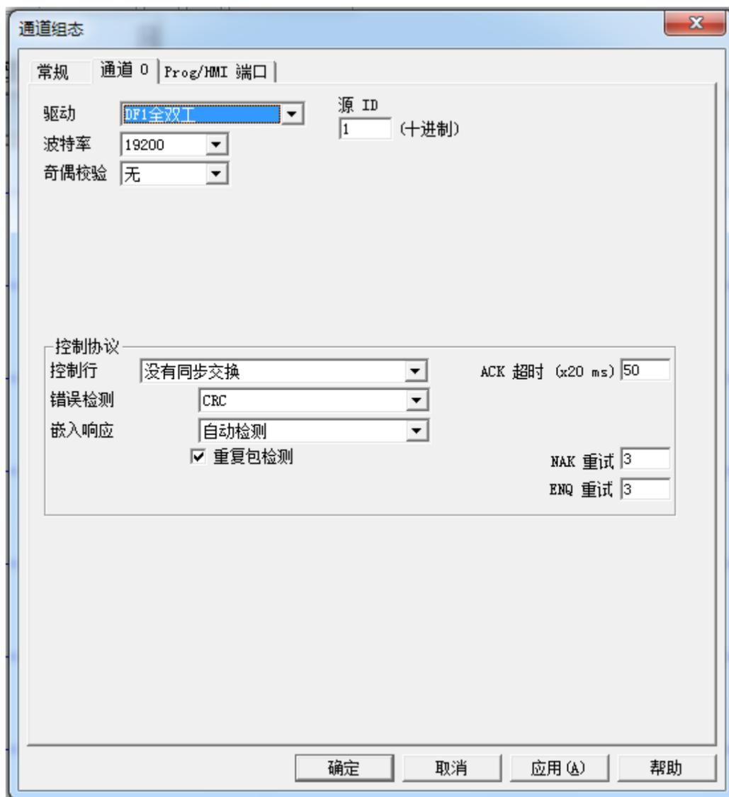
将参数设置完成后，下载到 PLC 中，断电重启 PLC 即可生效。
